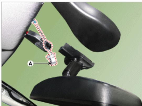
3. 如图所示的箭头方向向上拉并拆卸室内后视镜(A)。
